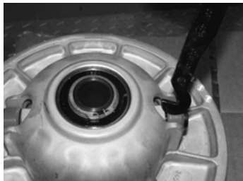
Установите загнутую часть инструмента внутрь.
