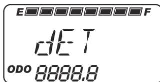
При возникновении критической детонации индикатор Check Engine начинает мигать с периодичностью, а на дисплее появится надпись "dET". (см. рисунок). Двигатель войдет в режим "возвращение домой" и обороты коленчатого вала двигателя будут ограничены 6500 об/мин. Двигатель останется в данном режиме до момента выключения.
