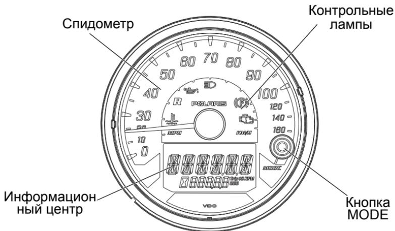
Цифровой прибор включает в себя спидометр, контрольные лампы, кнопку MODE и информационный центр водителя.
