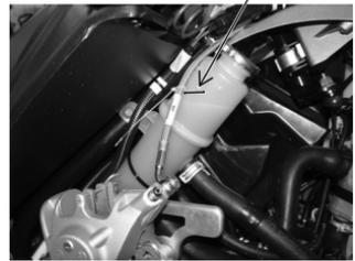
**ПРИМ.:** Эксплуатация снегохода с неисправной системой охлаждения может привести к перегреву и серьезной поломке двигателя. Обязательно поддерживайте рекомендуемый уровень охлаждающей жидкости.
