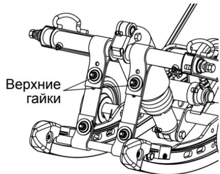
1. Снимите гайки и шайбы с верхней части ограничительных ремней.
