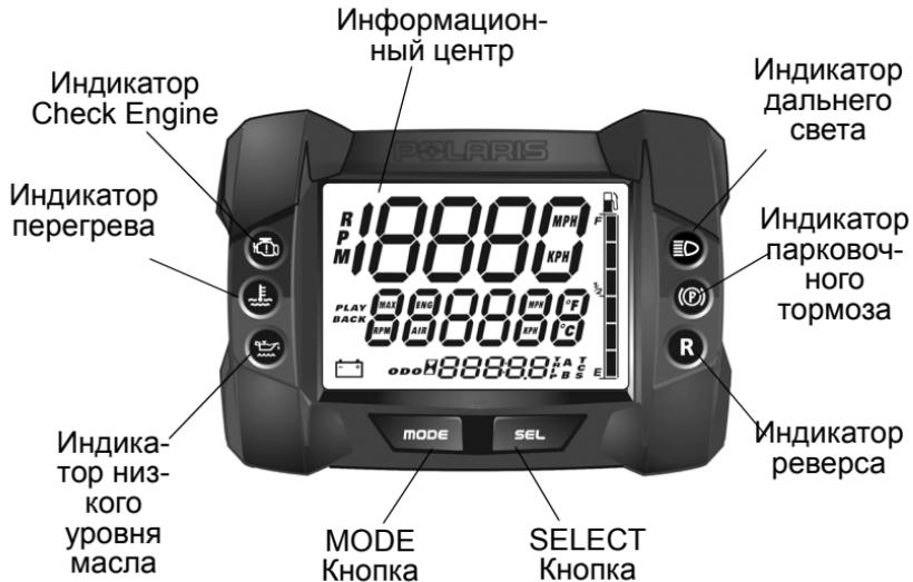
Цифровой прибор содержит индикаторы и информационный центр. Информационный центр можно контролировать с помощью кнопок MODE и SELECT на цифровом приборе или кнопкой MODE/SET на левой рукоятке руля или на консоли.
