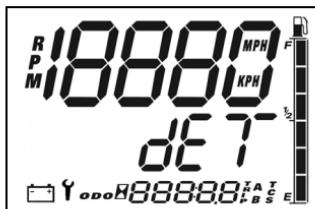
При возникновении критической детонации индикатор Check Engine начинает мигать с периодичностью а на дисплее появится надпись "dET". (см. рисунок). Двигатель войдет в режим "возвращение домой" и обороты коленчатого вала двигателя будут ограничены 6500 об/мин. Двигатель останется в данном режиме до момента выключения.
