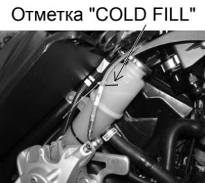
**ПРИМ.:** Эксплуатация снегохода с неисправной системой охлаждения может привести к перегреву и серьезной поломке двигателя. Обязательно поддерживайте рекомендуемый уровень охлаждающей жидкости.
