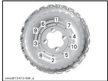
КОЛЕСА, ОСНАЩЕННЫЕ БЕДЛОКОМ С 10 БОЛТАМИ - ПОСЛЕДОВАТЕЛЬНОСТЬ ЗАТЯЖКИ (1-ЫЙ И 2-ОЙ ШАГИ)
