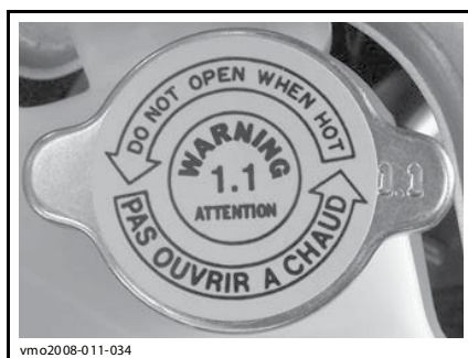
КРЫШКА РАСШИРИТЕЛЬНОГО БАЧКА
