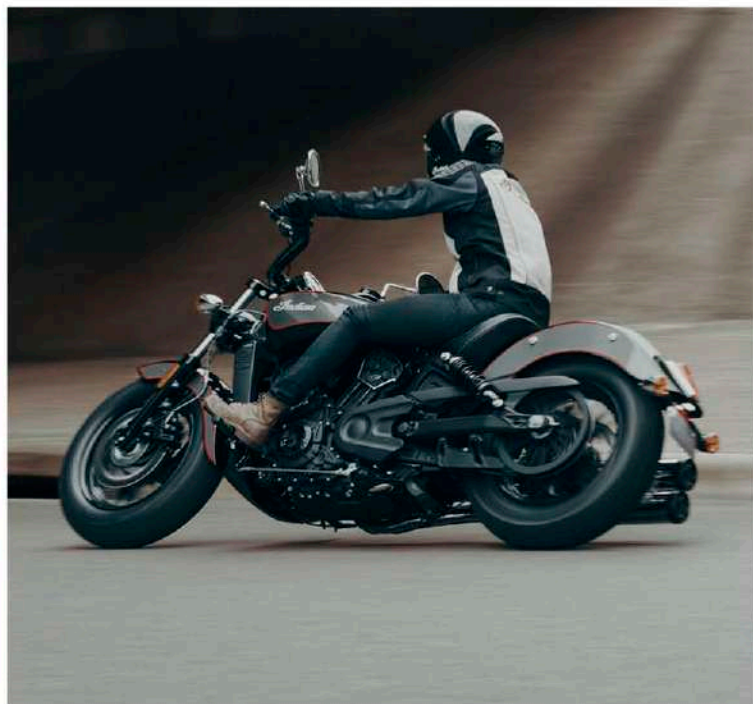
V-ОБРАЗНЫЙ ДВУХЦИЛИНДРОВЫЙ ДВИГАТЕЛЬ ЖИДКОСТНОГО ОХЛАЖДЕНИЯ С РАВОЧИМ ОБЪЕМОМ 999 КУБ. СМ
