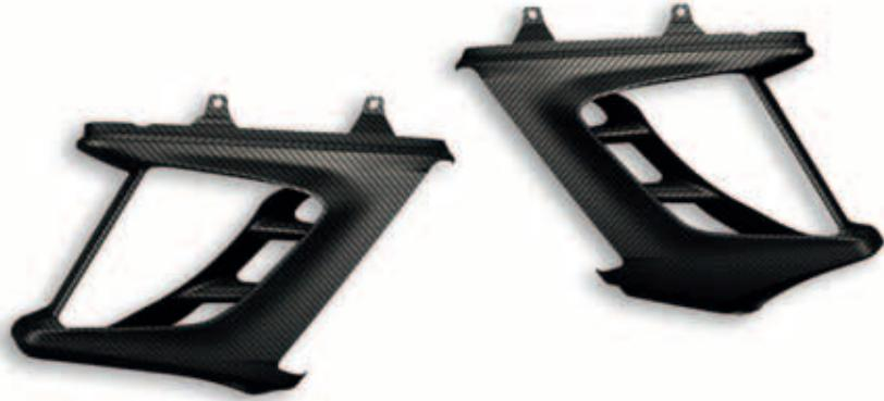
Cover serbatoio in fibra di carbonio. Leggera e sinuosa, si integra perfettamente con il cruscotto alloggiato sul serbatoio, rendendo ancor più esclusiva il tuo Diavel.
